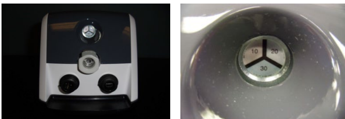
Figura 20 Indicador de humedad en la parte trasera del FTIR Cary 630 (izquierda) y primer plano (derecha).
