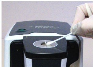
Figura 8 Limpieza del visor de muestreo de ATR de ZnSe de 5 rebotes.
