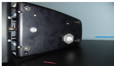
Figura 21 Ubicación del cartucho de desecante en la parte inferior del FTIR Cary 630.
