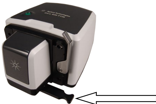
Figura 18 Accesorio de reflectancia difusa sujetado al Cary 630 FTIR. El soporte de la muestra se empuja en la ranura en la parte derecha inferior del accesorio.
